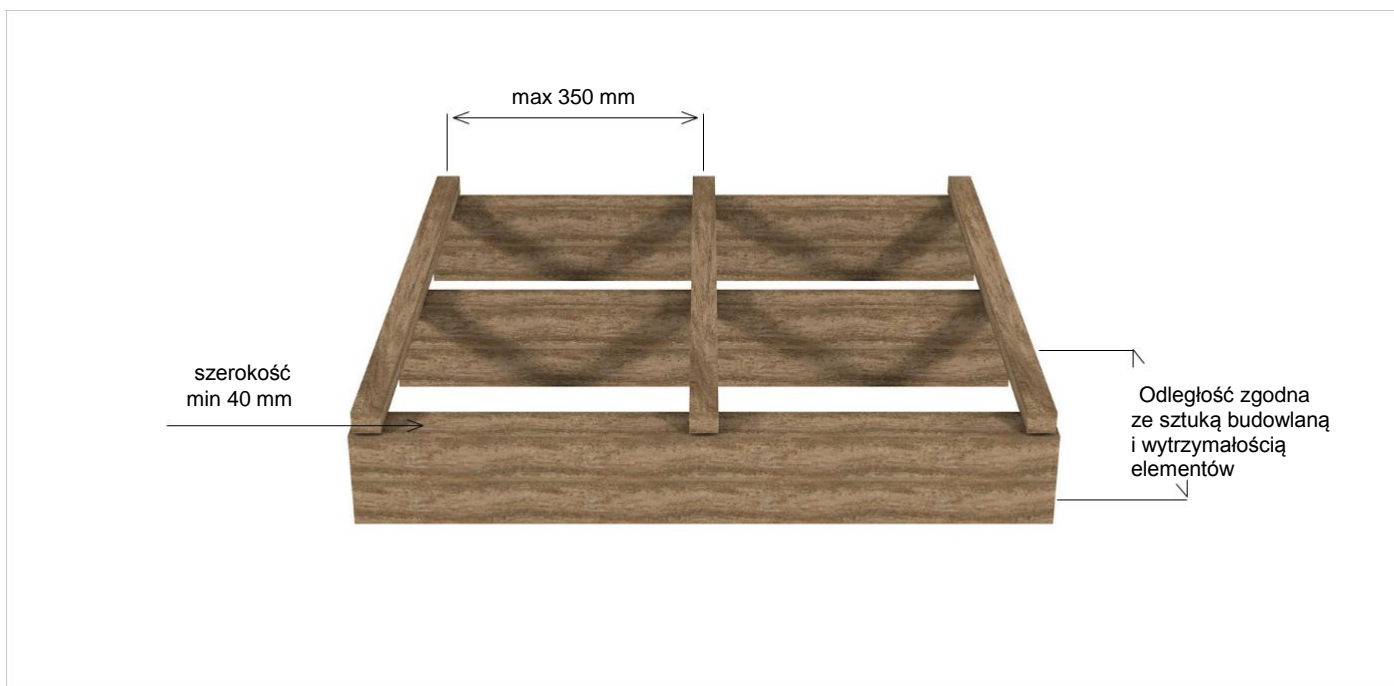
Rys 2. Legary na konstrukcji drewnianej
