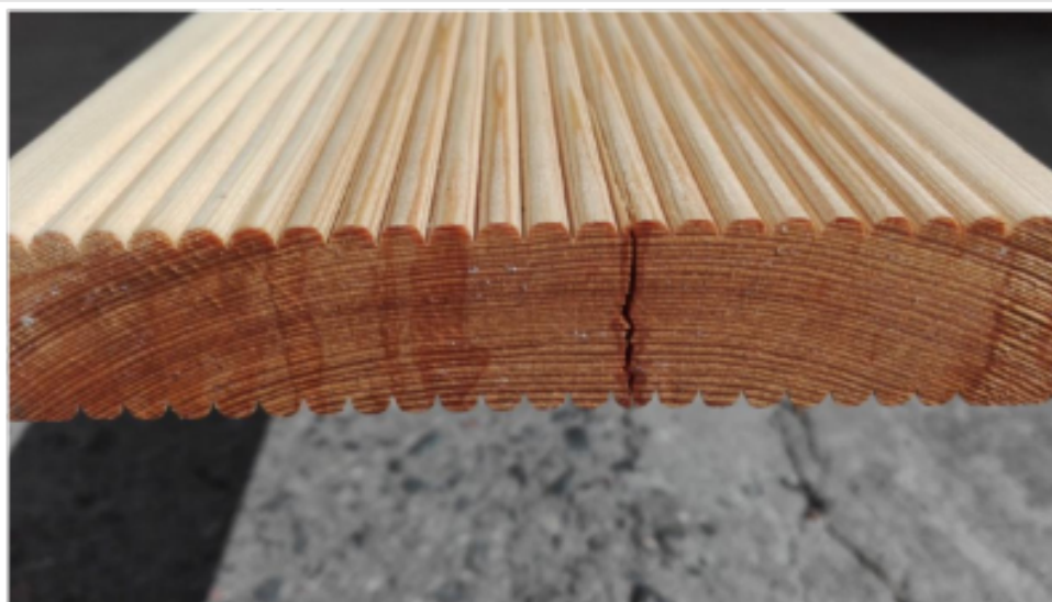
Fot. 18 - pęknięcie przechodzące czołowe
