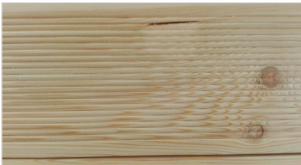
Fot. 1 - komora żywiczna
