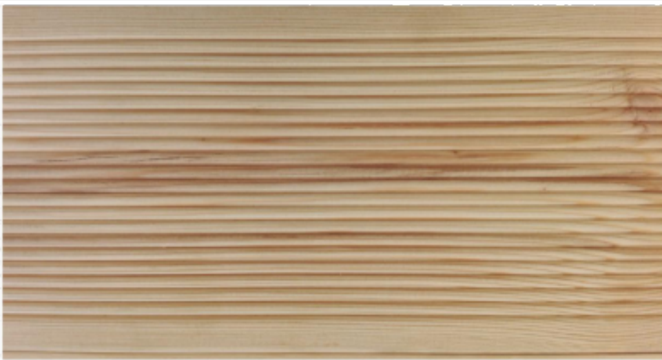
Fot. 8 - naturalne przebarwienia
