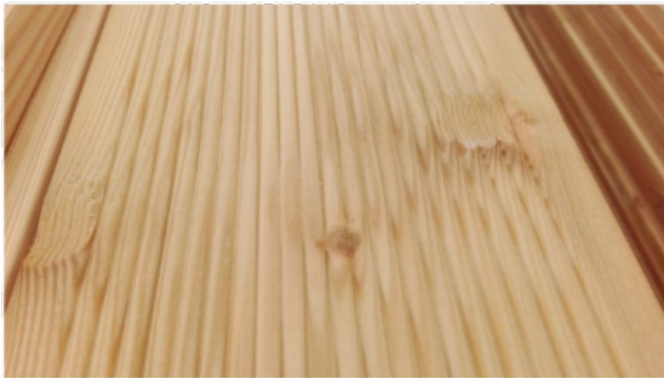
Fot. 22 - wyrwane włókna podczas obróbki
