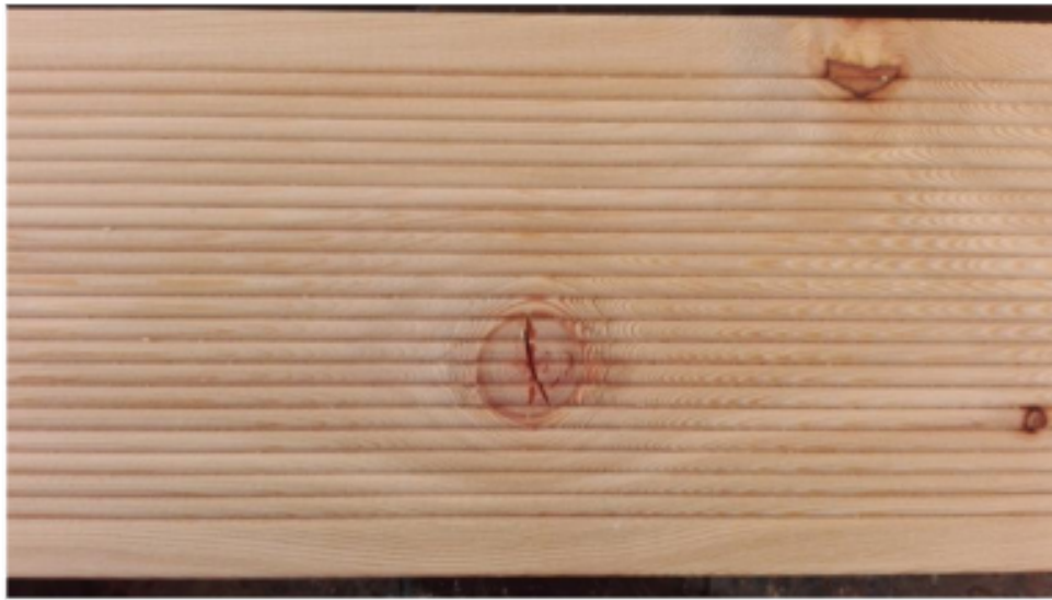
Fot. 21 - sęk spękany, wykruszony
