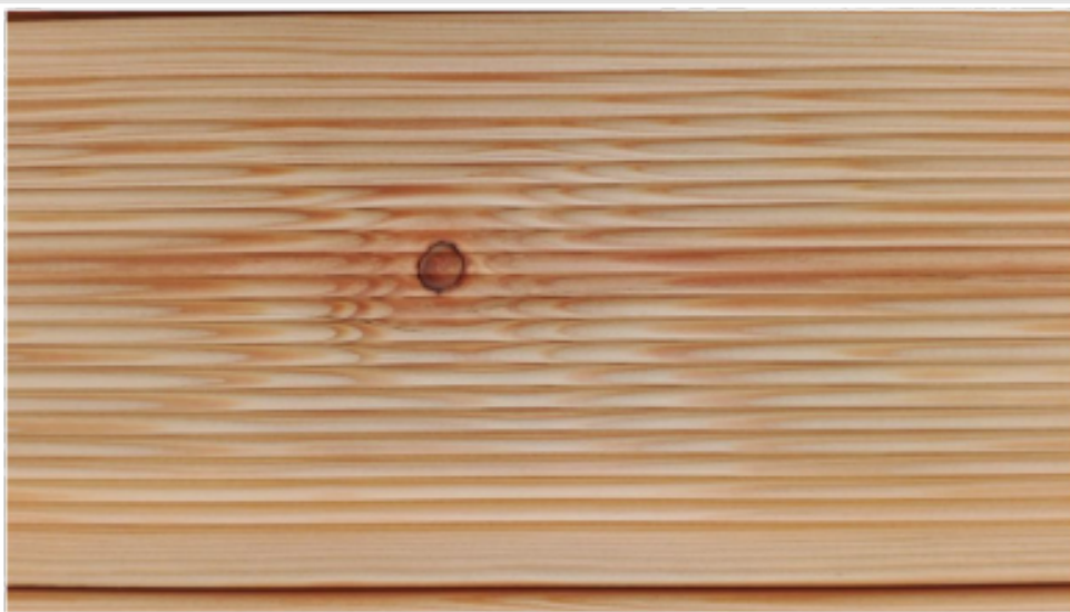
Fot. 6 - sęk czarny wrośnięty
