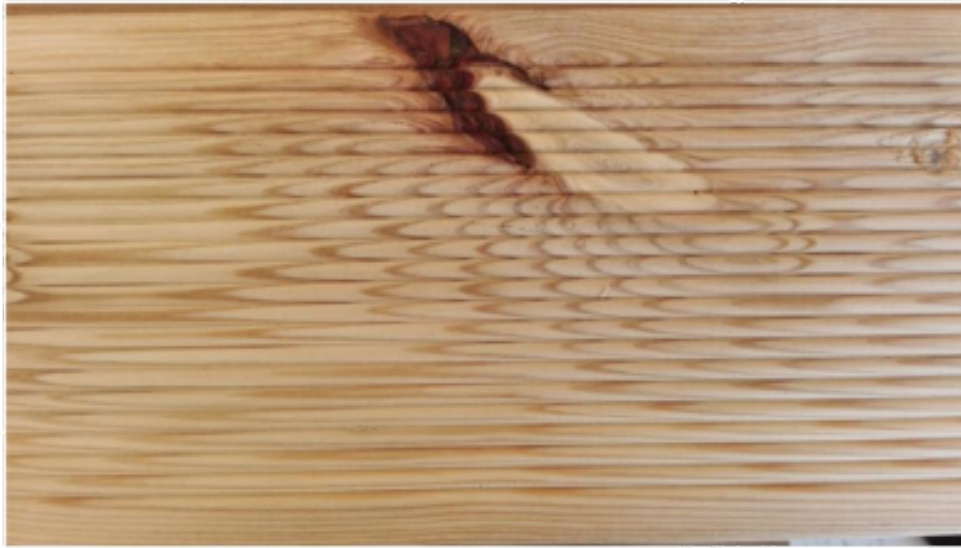
Fot. 19 - sęk z wrośniętą korą
