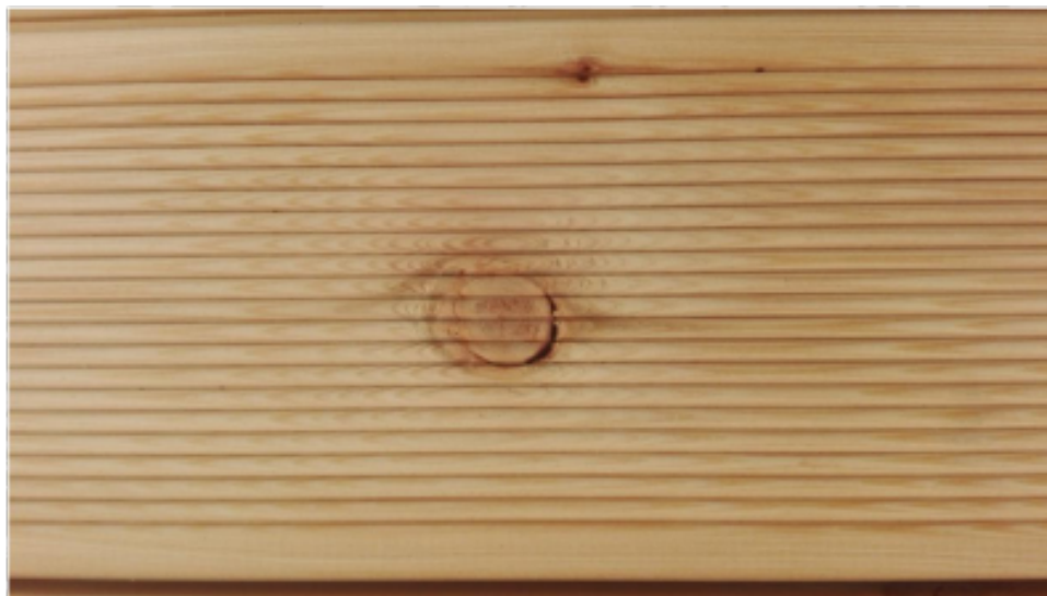
Fot. 17 - sęk z czarną otoczką zrośnięty w części obwodu
